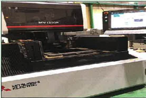
▲ 昨年新鋭の円筒研磨機（上）、ワイヤー加工機（下）を導入しました。操作性が良く高精度、高効率な加工が可能です。
